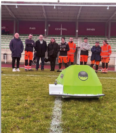
Le robot a une précision de traçage de 3 cm
